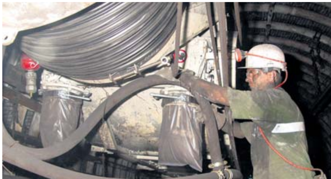
Zámečnick při údržbě odebrává zachycený uhelný prach z odlučovače.
