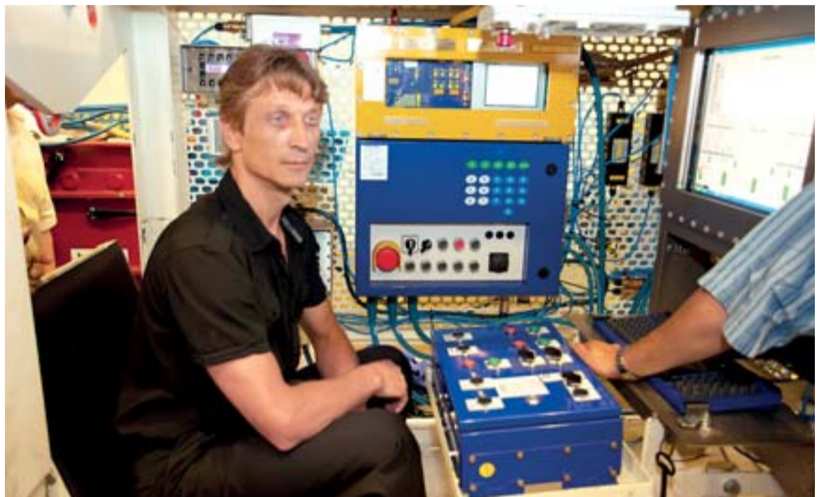
Řízení modifikovaného dobývacího komplexu GH 9-38 a navazujícího zařízení se bude odehrávat z povrchu, z řídicího stanoviště POP 2010, kterému v Paskově říkají Houston.
