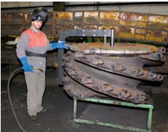
Bohumil Janík při opravě řezného orgánu průměru 1800 mm pro dobývací kombajn SL 300.
