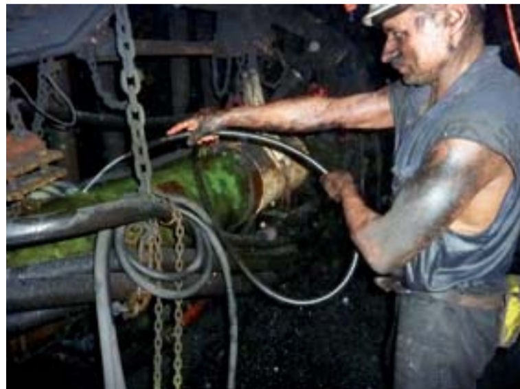
Na ranní směně v rubání 340 800. Údržba chladicí techniky.
