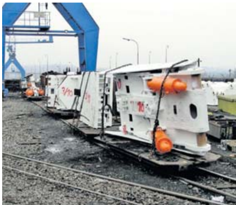
FAZOS 22/48/0,5 po generální opravě v PR před popuštěním do dolu.
